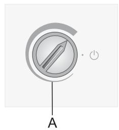
Если температура в помещении, где установлен прибор, ниже +16 °C, рекомендуем установить переключатель в область, обозначенную толстой линией.
