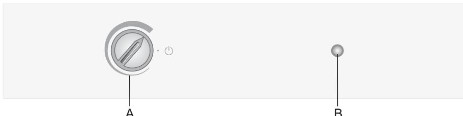
А Переключатель вкл./выкл. и установки температуры
