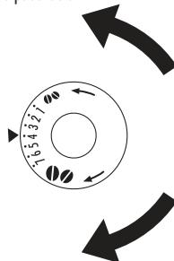
Для обеспечения более медленной подачи кофе и улучшения вида пенки поверните ручку на деление против часовой стрелки (более мелкий помол).
