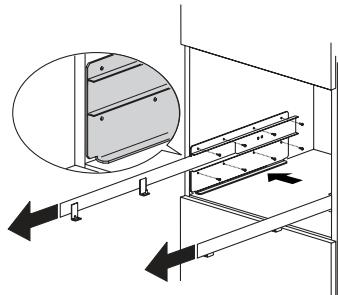
Установите направляющие на стенках стойки, как показано на рисунке. Закрепите направляющие соответствующими винтами, затем их полностью выдвиньте. В случае, если кофемашина установлена на печь для разогрева еды (макс. 500 Вт), используйте ее верхнюю поверхность, как точку отсчета для позиционирования направляющих.
